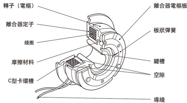
離合器由固定部件的定子和旋轉部件的轉子(電樞)與電樞板三個基本要素組成。
