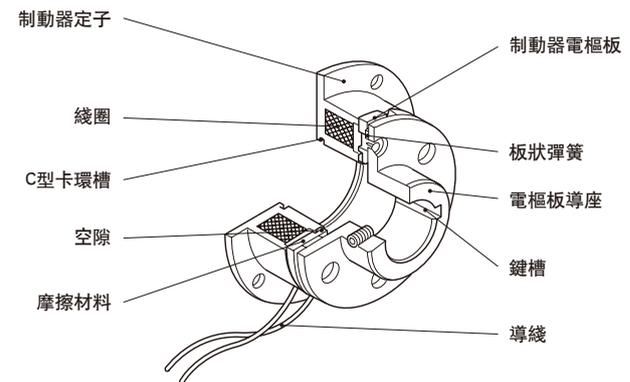
制動器由固定部件的定子和旋轉部件的電樞板兩個基本要素組成。
