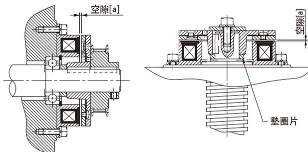
電樞 N 型是將電樞輪轂的輪轂部位置于定子內空間的獨特結構，十分緊湊，即使在制動器的前端安裝滑輪等，軸向的尺寸也不會變長。由于空轉扭矩為零，所以，即使安裝在縱軸上，也不會占用空間，並且，安裝簡便。空隙 [a] 可以通過墊圈及墊片簡便地進行設定。在進行調整時，只需要增減墊片的個數。
