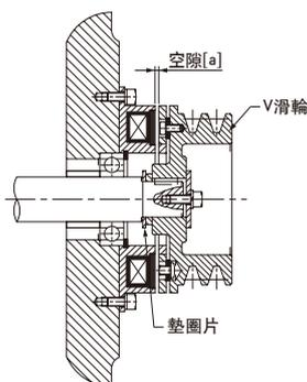
直接在 V 型皮帶輪的端面上安裝電樞，不需要電樞輪轂，並且，可以合理地進行安裝。適于安裝空間小及通過突出軸來減少對壁面懸掛負載的情況。
