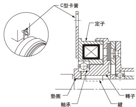
定子・轉子的安裝 (軸承安裝型)
