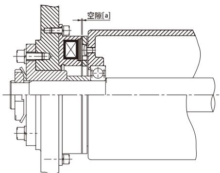
通過軸承直接將電樞安裝到懸浮在軸上的旋轉體（空轉滑輪或導向滾輪等）上，既簡單又可以不占用空間。空隙 [a] 可以通過墊圈及墊片簡便地進行設定。在進行調整時，只需要增減墊片的個數。
