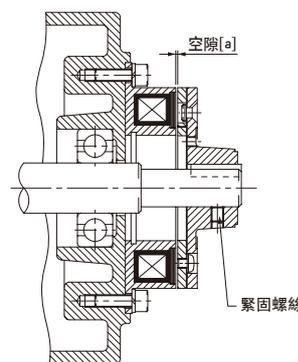
是一種安裝簡單的一種機型。可以輕鬆地安裝到現有機械上的需要停止、固定等的軸端部，而無需進行大幅度的改造及變更。空隙 [a] 的設定只需移動電樞 H 型，用定位螺絲進行固定，操作極其簡單。
